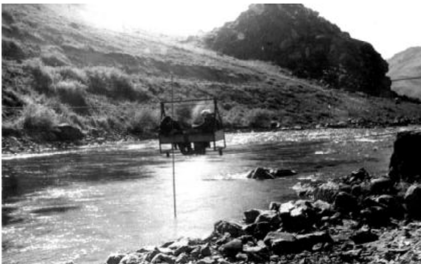
Замер расхода воды гидрологами в глубокую летнюю межень с гидрометрической люльки
